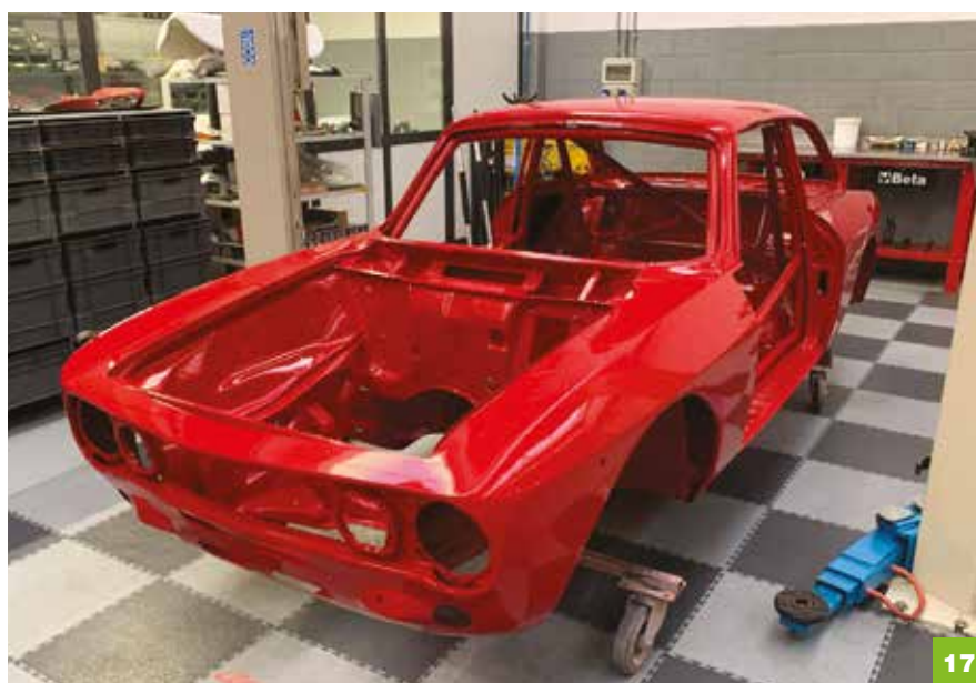
15, 16, 17, 18: La scocca è stata verniciata, sia all'interno che all'esterno, con il classico colore rosso "Alfa" 501.
